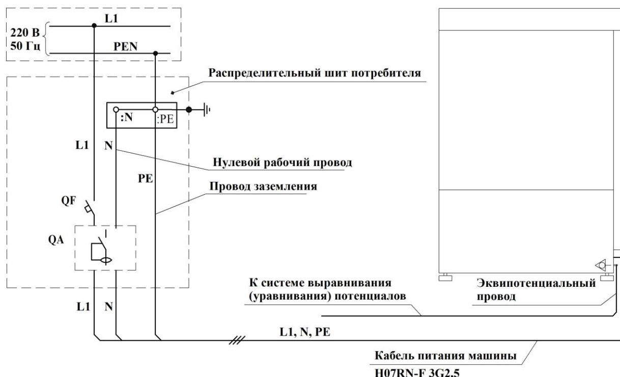
Рисунок 7 – Схема подключения к электрической сети
