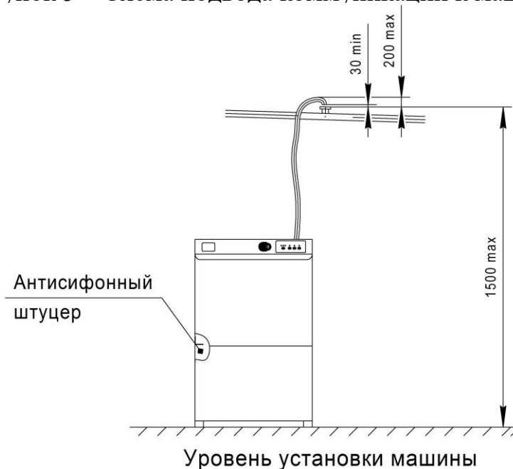
Рисунок 6 – Схема подключения к системе канализации при поставке машины с дренажным насосом
